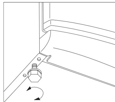
затяните винты. При установке холодильника проследите за тем, чтобы он был расположен горизонтально. Для этого используются 2 регулируемые ножки под передней частью холодильника.
