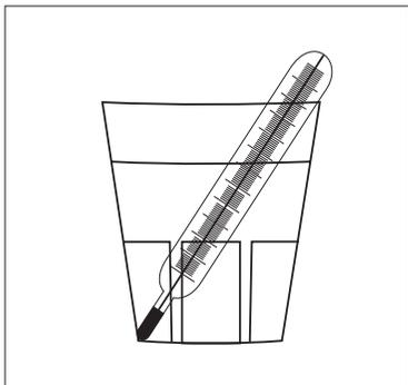
температуру продуктов, хранящихся в холодильнике, установите ручку терморегулятора в среднее положение, поставьте стакан с водой в центр камеры и опустите в него термометр с точностью градуировки  $\pm 1$  °C. Если через 6 часов показание термометра соответствует показанию дисплея, холодильник работает нормально. Измерения необходимо проводить в
